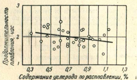
Рис. 30. Зависимость продолжительности плавления от содержания углерода по расплавлению (начало кампании по насадкам)
