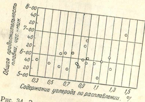
Рис. 34. Зависимость общей продолжительности плавки от содержания углерода по расплавлению (конец кампании по насадкам)
